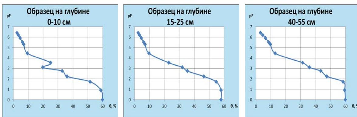
Рисунок 18. Определение основной гидрофизической характеристики серой лесной почвы методом центрифугирования.
