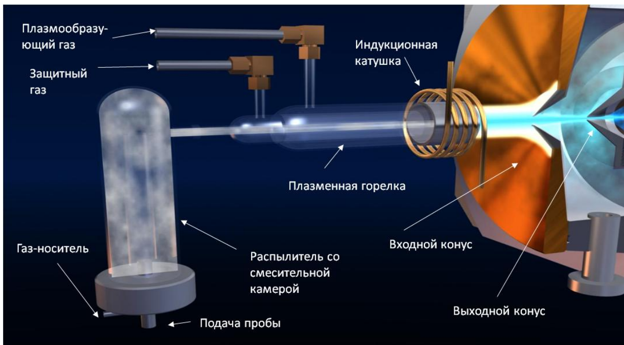
Рис. 1.2. Система ввода проб, плазменная горелка и вакуумный интерфейс (с разрешения Agilent Technologies)
