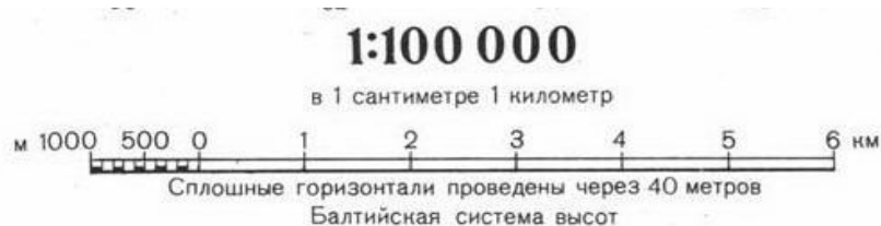
Рис. 2. – Подписи масштаба топографических карт (сверху вниз: численный, именованный, линейный).
